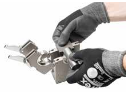
Un gabarit de centrage de tube, fixé à la cassette de serrage et donc imperdable, assure le positionnement exact du joint de tube à souder.
