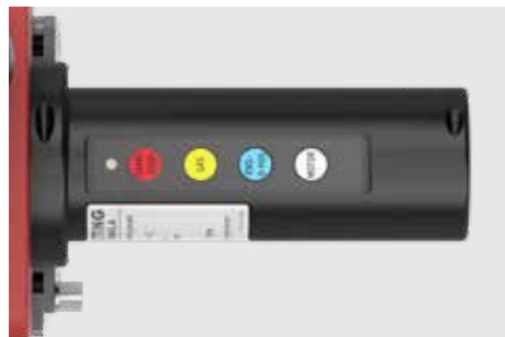
Panneau de commande intégré - toutes les commandes importantes pour le soudage peuvent ainsi être transmises à la source de courant, de sorte qu'aucune télécommande supplémentaire n'est nécessaire.
