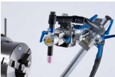
Brennerhalter mit Gelenken auf Kreuzschlitten zur Feineinstellung
