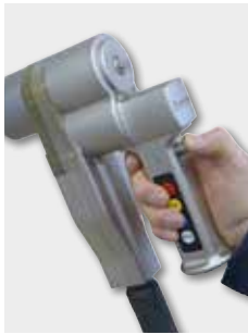
Einhandbedienung durch integrierte Fernbedienung und Pneumatikbetätigung im Handgriff
