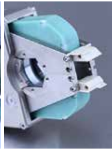
Aufklappbare Schweißkopfabdeckung "FlipCover"
