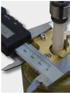
Einfache und präzise Einstellung der Elektrodenposition
