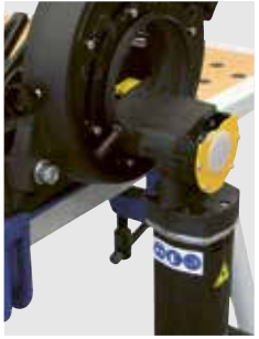
Avec deuxième attachement de lame de scie pour la désolidarisation par tronçonnage de coudes
