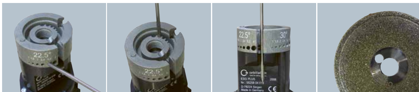
Affûtage des électrodes: 4 angles différents, 6 diamètres d'électrodes différents
