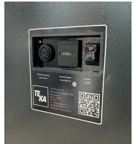
Übersichtliche Steuerung mit Betriebsstundenzähler und Signalhupe
