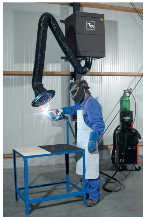
Anwendungsbeispiel: CareMaster wandmontiert mit zusätzlicher Düsenplatte an der Absaughaube
