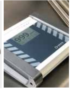
Umfangreiches Zubehörprogramm, z.B. ORBmax Restsauerstoffmessgerät
