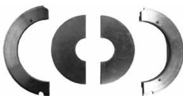
Einsatz zum Bogenschweißen (Grundaufnahme/Abdeckscheibe)
