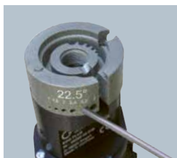
Affûtage des électrodes: 4 angles différents, 6 diamètres d'électrodes différents
