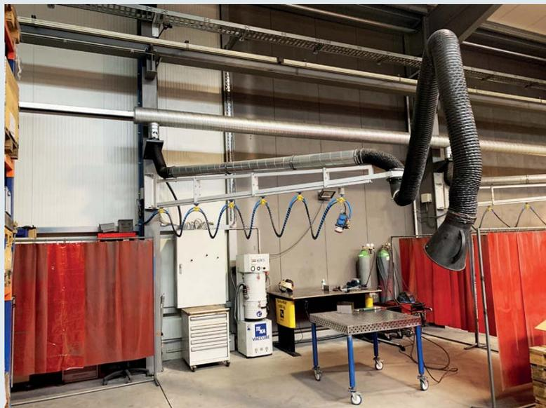
Absaugarm mit Wandausleger und Führungsschiene
