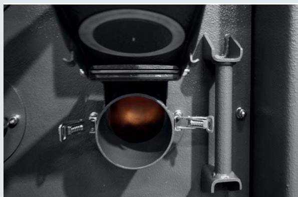
Raccordements frontaux pour jusqu'à 6 flexibles
