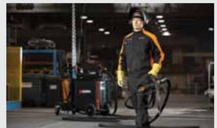
L'utilisation d'un dévidoir auxiliaire léger constitue une option plus ergonomique que le transport de grands dévidoirs lourds ou le soudage avec des torches push/pull lourdes qui augmentent les tensions sur le poignet du soudeur.
