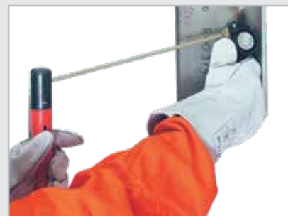
Die schnurlosen Fernregler R11-T können durch einfaches Berühren der Elektrode verwendet werden
