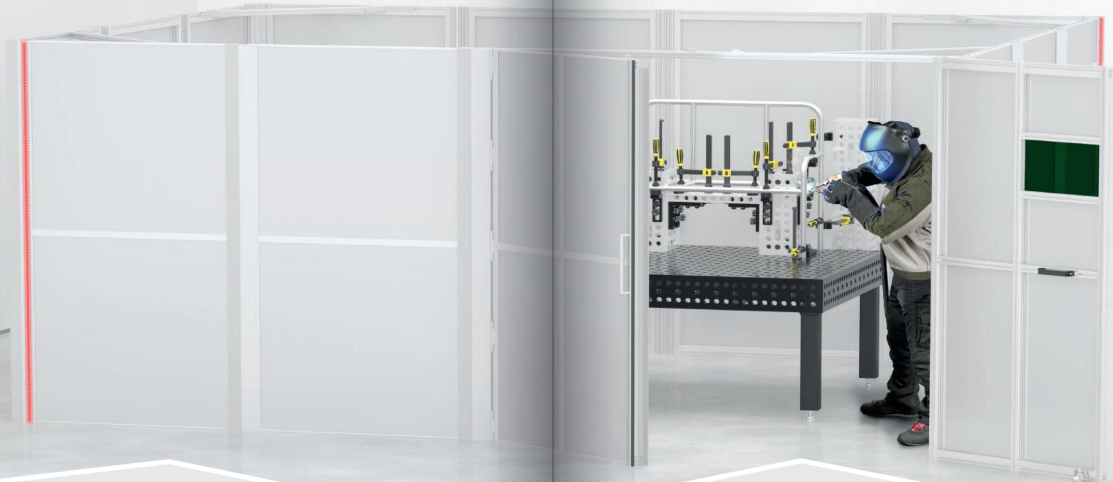
Photo démol Pendant le processus de soudure les portes doivent être fermées.
