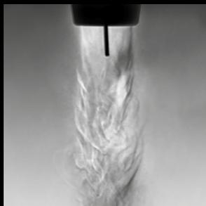
Le débit de gaz de protection a un impact important sur la qualité de soudage. Normalement, le gaz de protection est invisible, mais grâce à la technologie d'imagerie Schlieren, il est possible d'observer le débit de gaz réel. Cette technologie illustre de quelle façon le design de la torche de soudage et les consommables Flexlite GX permettent un flux de gaz laminaire ainsi qu'une meilleure couverture du gaz de protection.
